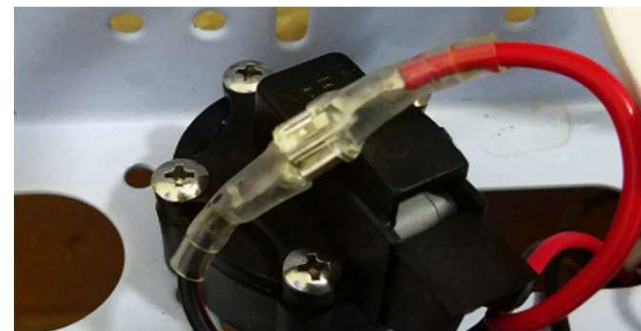
Gài 2 đầu dây van áp thấp vào với nhau
