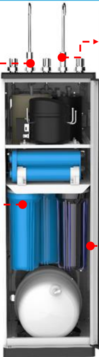
Bước 5 : Lắp lõi 1&2, không lắp cốc 3, xả rửa riêng lõi than số 2 (5 phút)
