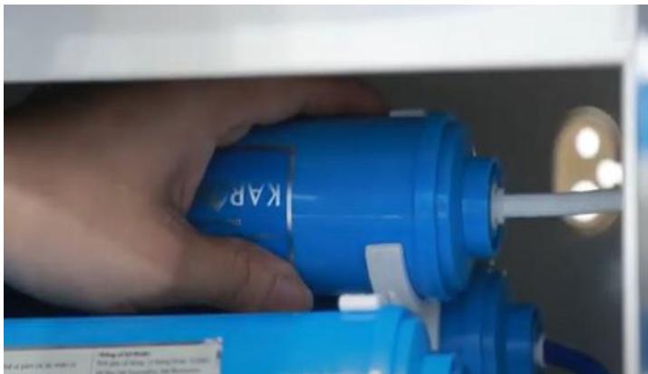
1. Kết nối đường nước tinh khiết với vòi sử dụng
