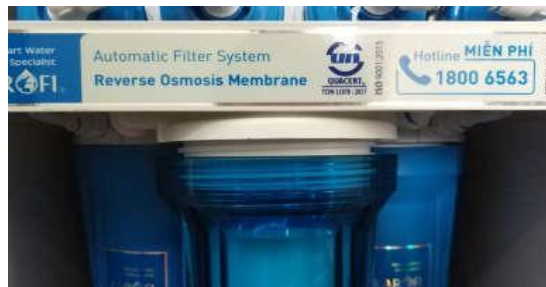
2. Lắp lõi OCB - Mở lỏng cốc số 1 (Không lắp lõi số 1 và số 3)
